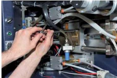
Sostituire la guarnizione interna della flangia
