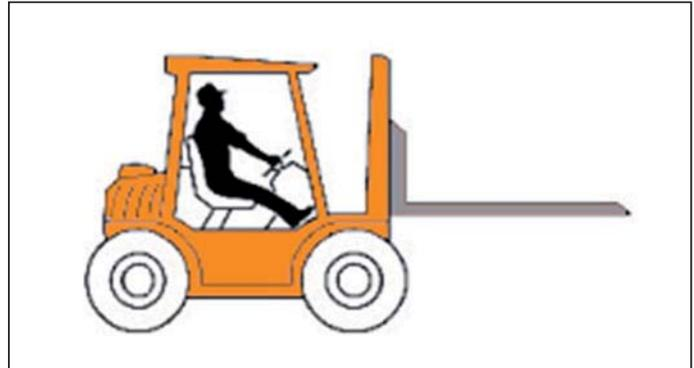
Il mezzo impiegato per il sollevamento e la movimentazione deve avere le appendici in buono stato, non danneggiate e/o non deteriorate ed almeno lunghe 1500mm.
