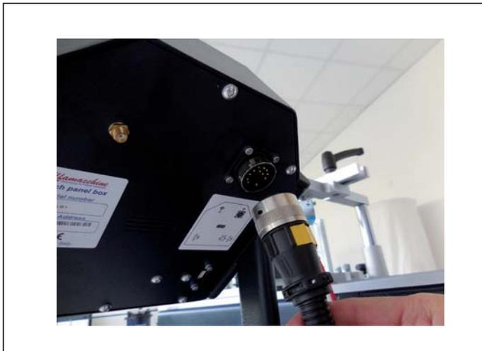
8. Non forzare e una volta inserito, ruotare la ghiera in senso orario fino al suo completo bloccaggio.
