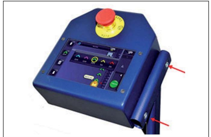
5. Fissare l'unità di controllo nell'apposito supporto, con le due viti fornite secondo l'inclinazione desiderata.
