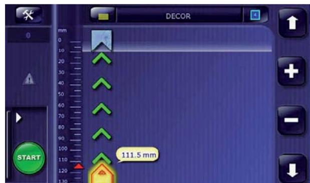
Il sistema di "autopiattamento" propone la disposizione delle Graffe e quantità in funzione della dimensione dell'asta;
