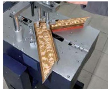
Premere il pedale per il bloccaggio verticale e successivamente il tasto start sul touch screen.
